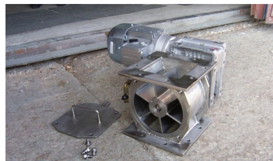
Rys. 3. Dozownik celkowy ze zdemontowaną pokrywą rewizyjną
